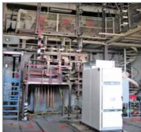
Ćelija pripremljena za ispitivanje na kratak spoj (CESI Milan, Italija)
