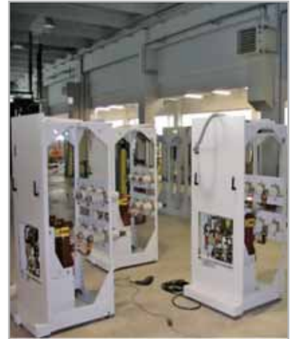
Izvlačivi dio ćelije nakon retrofita sa fiksnim prekidačem
