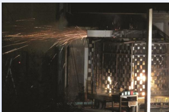
Ćelije u postupku testiranja otpornosti na luk (arc proof)
