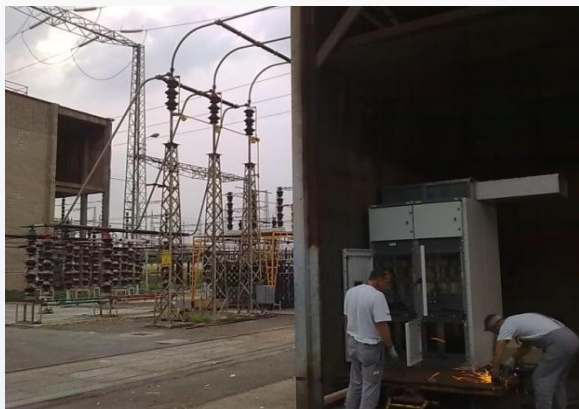
Priprema ćelije za testiranje otpornosti na luk
